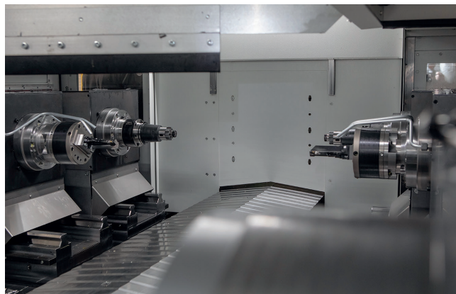
4 Allein 2020 waren 16 Ceratizit-Planschieber in diversen Versionen bei HK-CON in Gebrauch. Außer PKE-Einfachschiebern gehören dazu die zweischneidigen PKD-Doppelschieber KOMdrive, mit denen sich die Drehzahlen steigern und so die Taktzeiten weiter verkürzen lassen © Ceratizit
